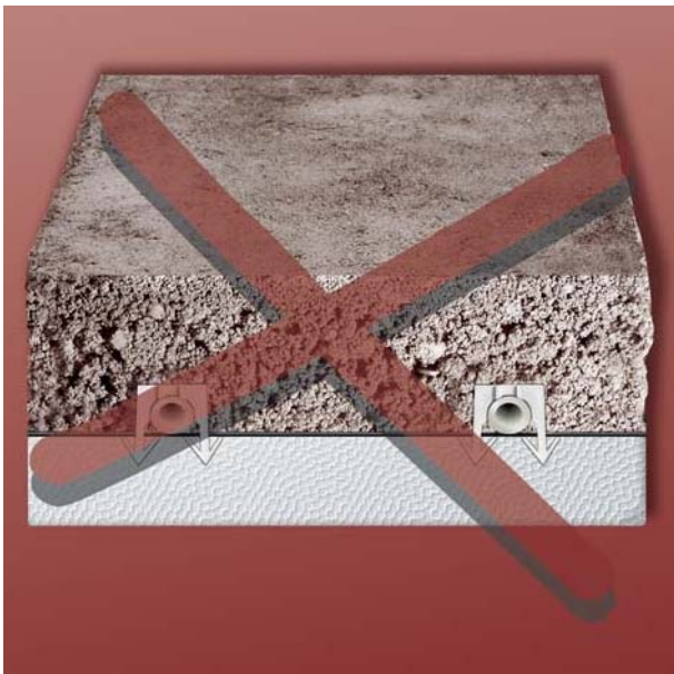
Цементный бесшовный пол без добавок фирмы "Керми" для улучшения качества бесшовного пола типа EV 21 или ES 10
