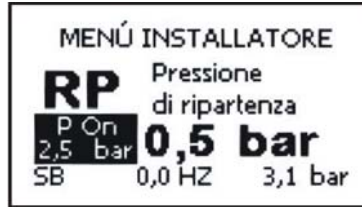
Figure 17: Configuration de la pression de redémarrage
