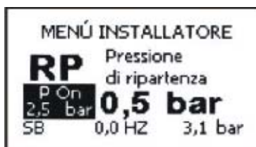
Σχήμα 17: Ρύθμιση της πίεσης επανεκκίνησης
