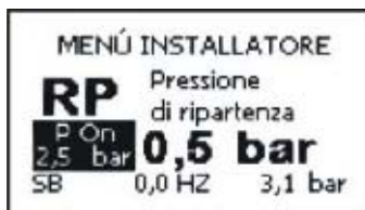
17.ábra: Az újraindítási nyomás beállítása
