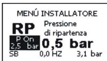
Рисунок 17: Настройка давления нового включения
