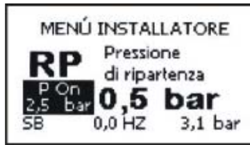
Abbildung 17: Einstellung des Neustartdrucks
