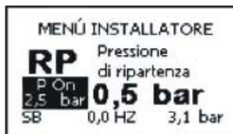
Rys. 17: Ustawienie ciśnienia wyzwalającego uruchomienie
