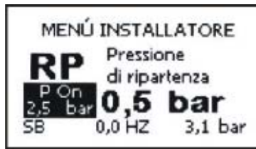
Afbeelding 17: instelling van de druk voor herstart
