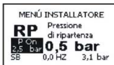
Figura 17: Configuración de la presión por re arranque
