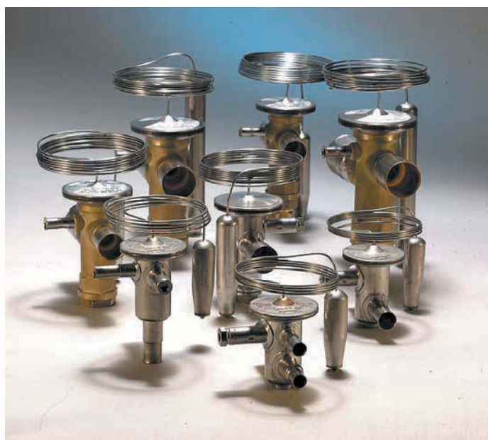
Терморегулирующие вентили с внешним выравниванием давления (ТРВ)
