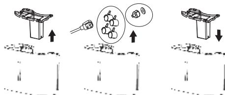
Наклоните прибор не ниже чем на 45 градусов и с небольшим усилием вставьте пластиковые шасси в специальные пазы.
