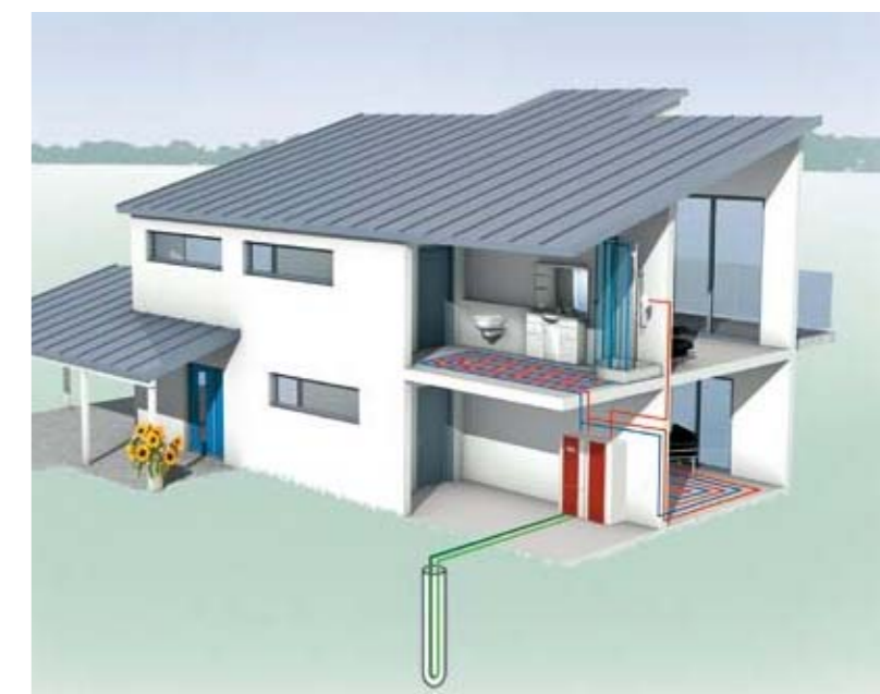
Тепловой насос типа "соляной раствор-вода" с грунтовыми зондами
