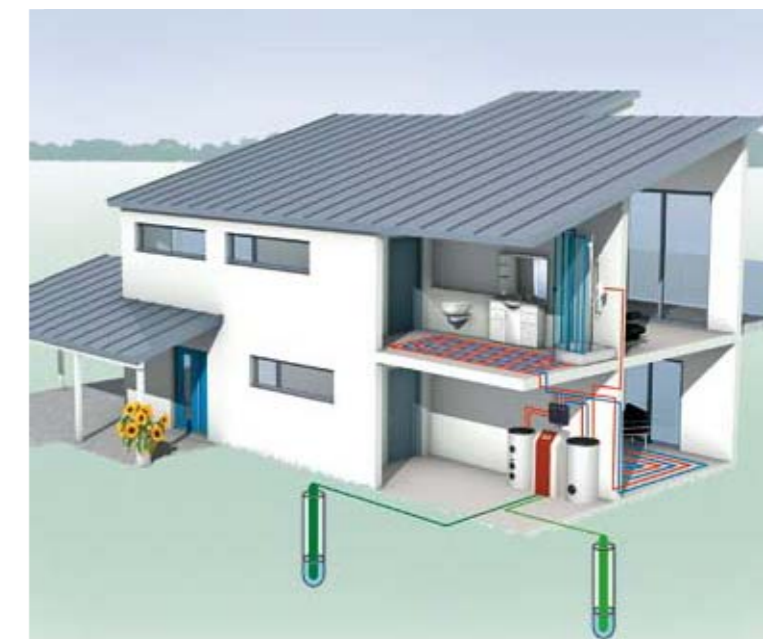
Тепловой насос типа "вода-вода" с водозабором грунтовых вод
