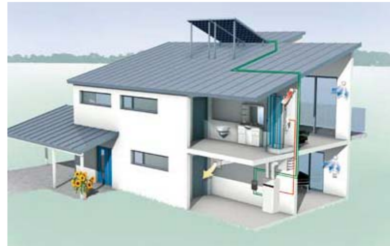
Солнечные коллекторы в сочетании с компактной вентиляционной установкой LWP 300W со встроенной системой приготовления горячей воды
