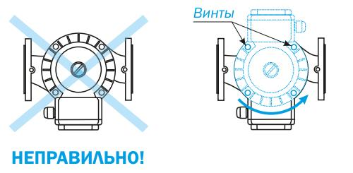
**Расположение клеммной коробки, в случае необходимости можно изменить следующим способом:**
