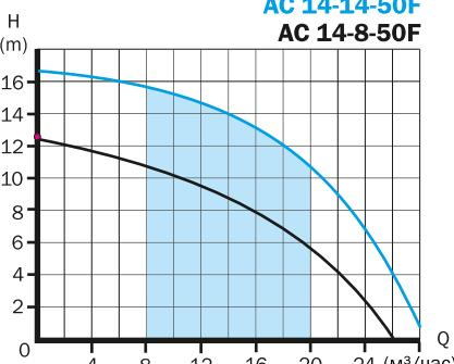
Приведенные характеристики справедливы при условии перекачивания чистой воды температурой 25 °C, при напряжении в сети питания 220В. Производитель оставляет за собой право незначительно менять конструкцию и характеристики насосов без специального уведомления.
