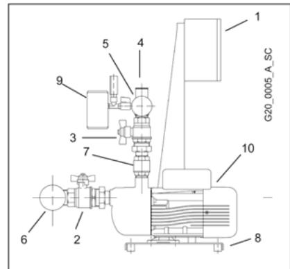
A seconda del tipo di gruppo la valvola di ritegno può essere in mandata o in aspirazione, l'eletropompa può essere del tipo verticale od orizzontale.
