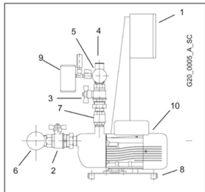
Suivant le type de groupe la soupe de retenue peut être sur le refoulement ou sur l'aspiration, l'électropompe peut être de type vertical ou horizontal.
