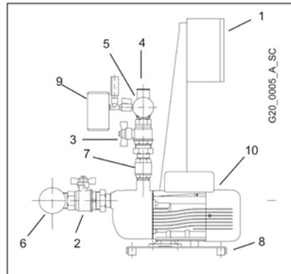
De acordo com o tipo de unidade, a válvula de retenção pode estar na elevação ou na aspiração. A electrobomba pode ser do tipo vertical ou horizontal.
