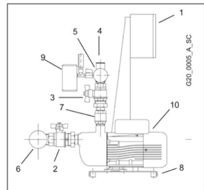
Je nach Art der Anlage kann das Rückschlagventil druck- oder saugseitig angebracht sein. Die Motorpumpe kann vertikal oder horizontal ausgeführt sein.
