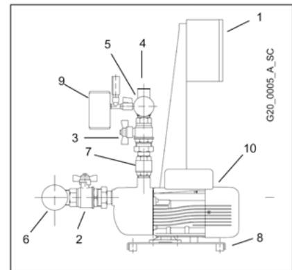
Según el tipo de grupo, se puede instalar la válvula de retención en impulsión o en aspiración y la electrobomba puede ser de tipo vertical u horizontal.
