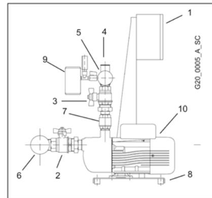
Al naargelang het type groep kan de balkeerklep op de persleiding of op de aanzuigleiding geplaatst zijn en kan de elektropomp van het verticale of het horizontale type zijn.
