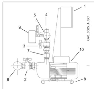
Запорный клапан может находиться в выпускной или выпускной стороне в зависимости от типа установки; электрический насос может быть вертикального или горизонтального типа.
