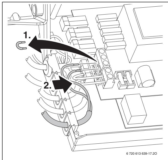
Рис 15 Подключение (230 В переменного тока, удалить перемычку между ТН1 и ТН2)
