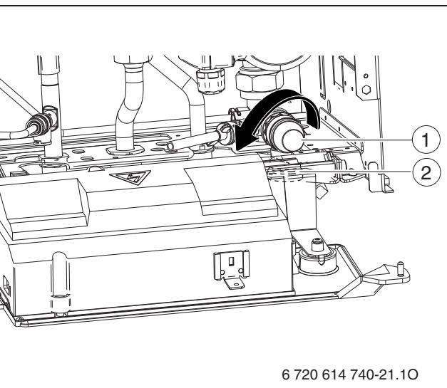
Рис. 39 Предохранительный клапан
