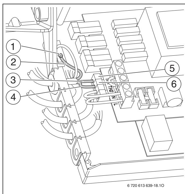
Рис 16 Подключение сетевого кабеля 230 В перемен. тока
