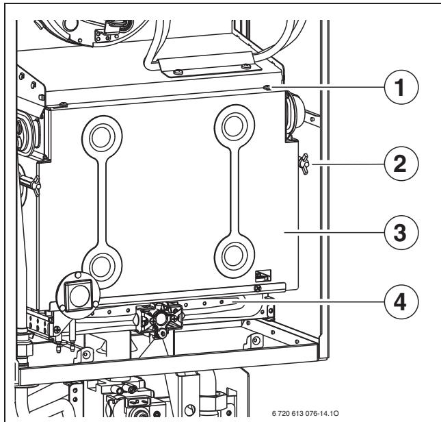
Рис 34 Открывание горелки
