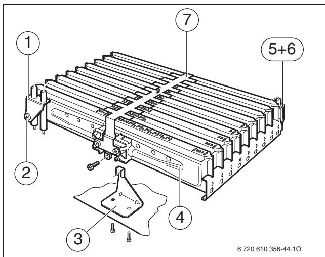
Рис 35 Узел горелки
