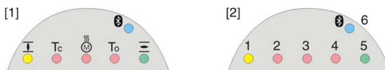
рис. 54: Расположение ламп и описание ламповой индикации
