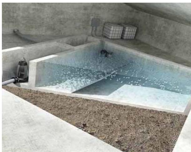
Процессы флокуляции и образования осадка широко применяются при подготовке питьевой воды. Флокулянты используются в процессе водоподготовки для укрупнения мелких взвешенных частиц, способствующих образованию осадка или фильтрованию малых частиц, что способствует удалению микроскопических частиц, которые приводят к повышенной мутности воды и которые достаточно сложно или даже невозможно удалить с помощью одной только фильтрации.
