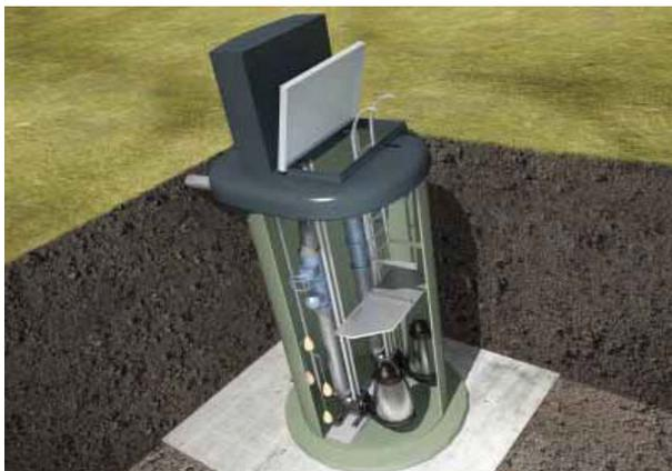
Сетевая насосная станция обеспечивает сбор и перекачивание стоков к более крупным насосным станциям. Grundfos поставляет комплектные сетевые насосные станции, в том числе и по спецификациям заказчика, с учетом всех требований к размеру и конструкции. Компания предлагает комплектные готовые насосные станции в стеклопластиковом резервуаре оснащенные насосами, датчиком уровня и интеллектуальной системой управления. При необходимости, возможно включение решений по дозированию реагентов.
