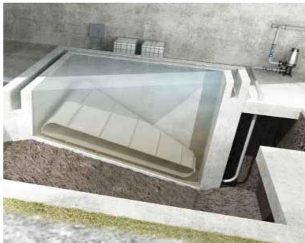
Образование осадка представляет собой процесс физической очистки воды, используемый для осаждения взвешенных частиц в воде под воздействием силы тяжести. Одним из требований правильного образования осадка является поддержание медленного потока воды с помощью насосной системы, предназначенной для того, чтобы исключить контакт осадка и важных частей насоса, тем самым уменьшая риск износа оборудования.
