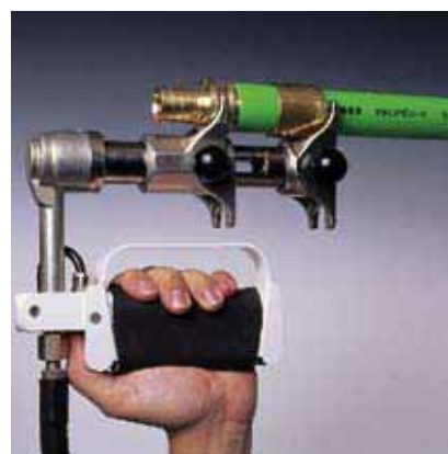
Рис. 12 6. Вставить соединение в запрессовочную насадку (тиски) без перекоса
