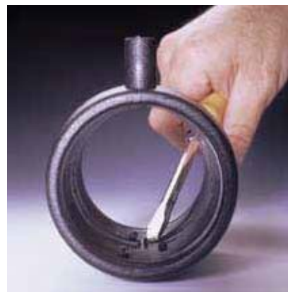
Рис. 64 Если муфта используется в качестве подвижной, то из нее следует удалить упорные nipples
