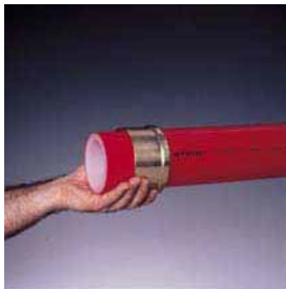
Рис. 16 2. Надеть на трубу подвижную гильзу фаской в сторону фитинга
