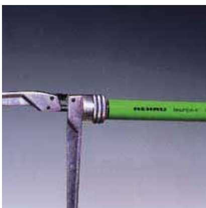
Рис. 10 4. Произвести развальцовку трубы в два приема, повернув трубу относительно расширительной насадки после первой развальцовки на 30°
