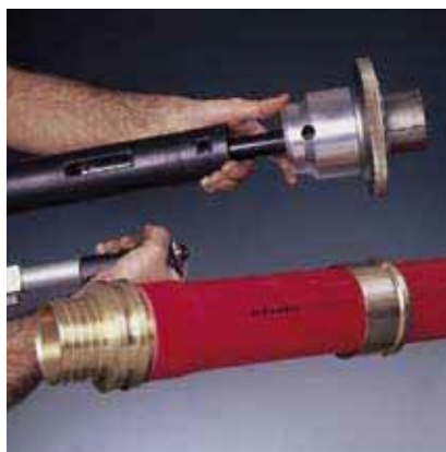
Рис. 19 5. Снять расширительную насадку
