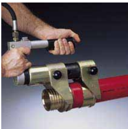
Рис. 21 7. Вставить соединение в запрессовочную насадку (тиски) без перекоса
