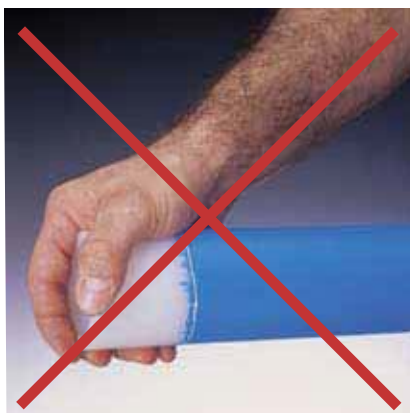
Рис. 59 К зоне сварки нельзя прикасаться руками
