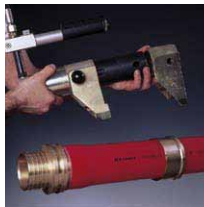
Рис. 20 6. Надеть запрессовочную насадку на цилиндр
