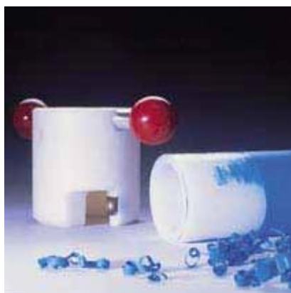
Рис. 57 Если используется автоматическое устройство для снятия верхнего слоя трубы, то его следует прогнать только один раз. Остатки цветного слоя не влияют на процесс сварки, если был удален верхний слой
