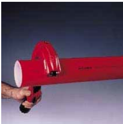
Рис. 15 1. Отрезать трубу по размеру под прямым углом
