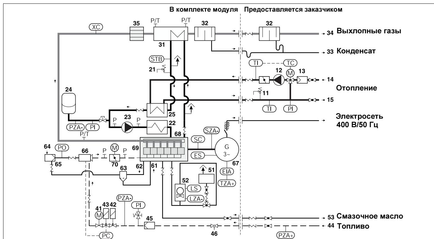
Рис. 2 Устройства контроля
