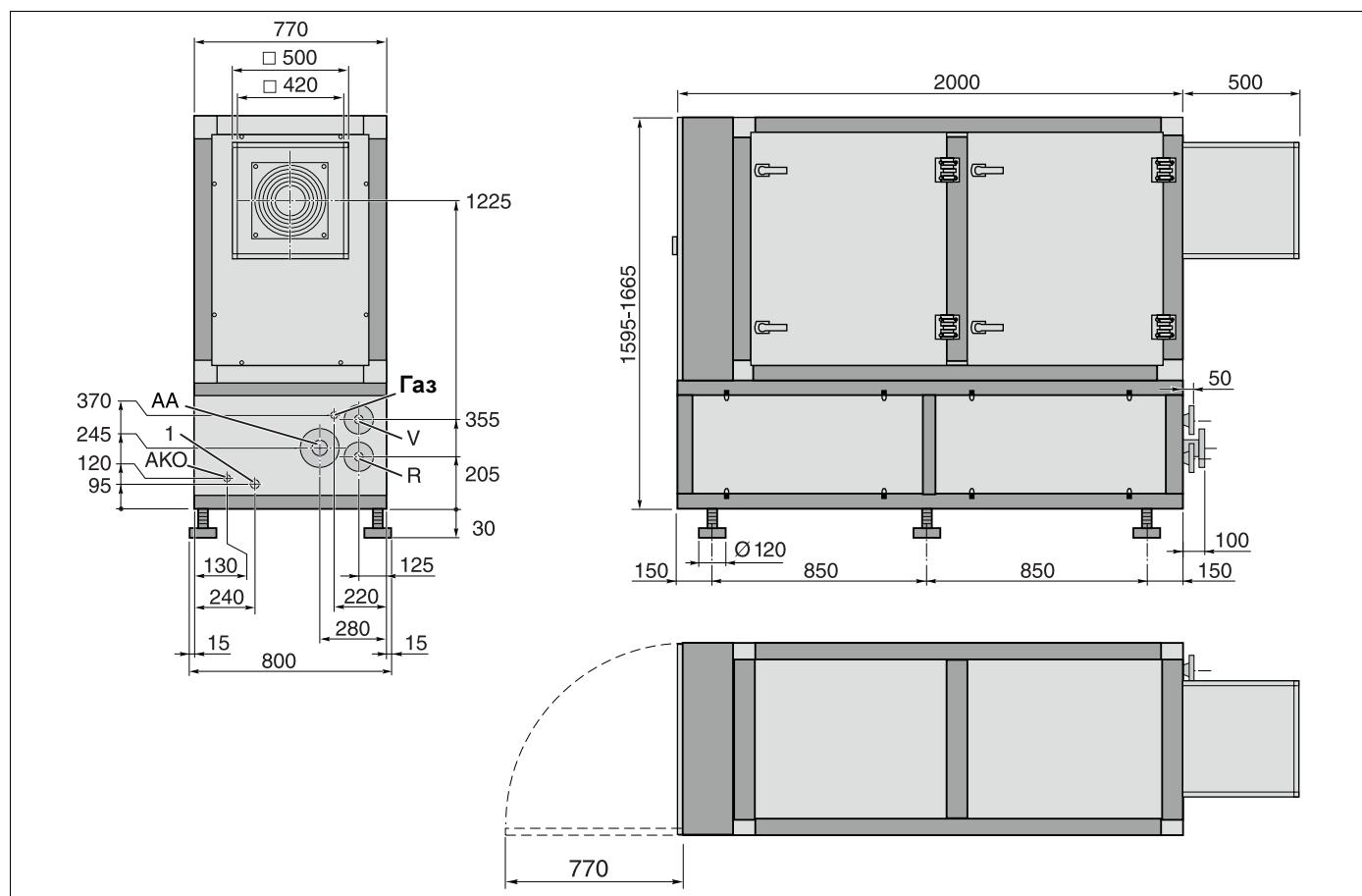
Рис. 4 Размеры (мм)
