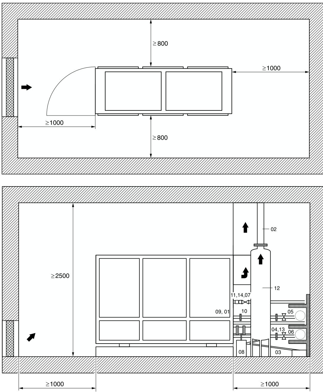
Рис. 5 Примеры установки – изображение без арматуры и приборов безопасности (размеры в мм)
