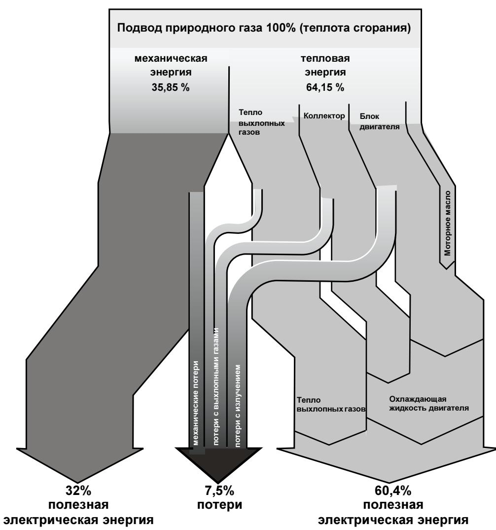
Рис. 1 Энергетический баланс модуля блок-ТЭС
