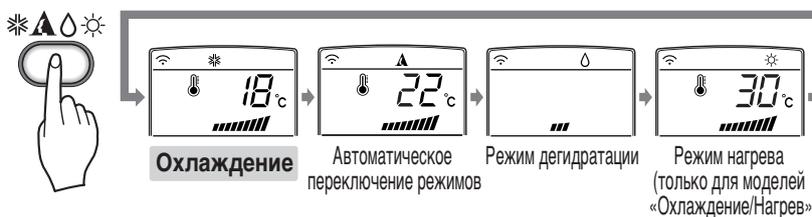
Работа в автоматическом режиме (Для моделей только с режимом охлаждения)
