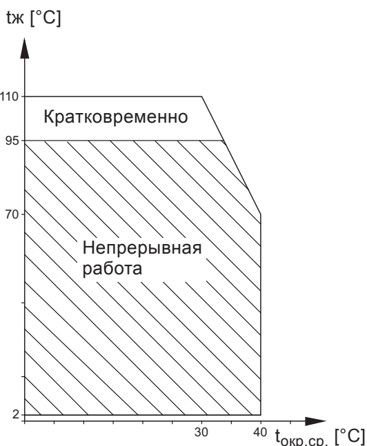
Рис. 28 GRUNDFOS MAGNA A/C – температура жидкости в зависимости от температуры окружающей среды
