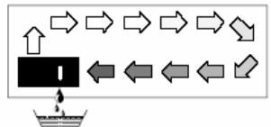
Поток воздуха охлаждается по пути сквозь/через испаритель-конденсатор, пока его температура не опускается ниже температуры точки росы. Водяной пар конденсируется и собирается в конденсационном лотке и дrenируется.
