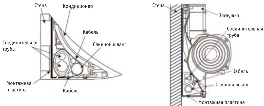
Расположите соединительные трубы, кабель, сливной шланг так, как показано на рисунке, а затем подсоедините дренажный шланг к сливному отверстию.
