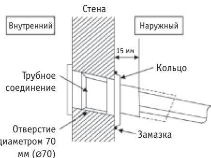
Просверлите отверстие для трубы диаметром 70мм внизу справа или слева от монтажной пластины. Отверстие должно быть слегка наклонено наружу.
