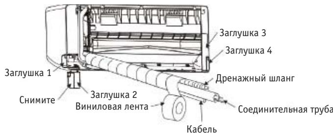
Дренажные шланги могут быть подсоединенены к отверстиям 1 и 2. Если появится необходимость подсоединить дренажный шланг к другому отверстию, то снимите с этой стороны резиновую пробку и зафиксируйте дренажный шланг, а затем вставьте резиновую пробку в освободившееся отверстие, чтобы закрыть его.
