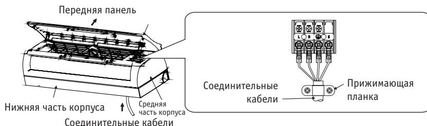
Откройте переднюю панель, если во внутреннем блоке есть сигнальный провод, пожалуйста, отсоедините среднюю часть корпуса и пропустите провод через нижнюю часть корпуса, а затем соедините сигнальные провода внутреннего и наружного блоков.
