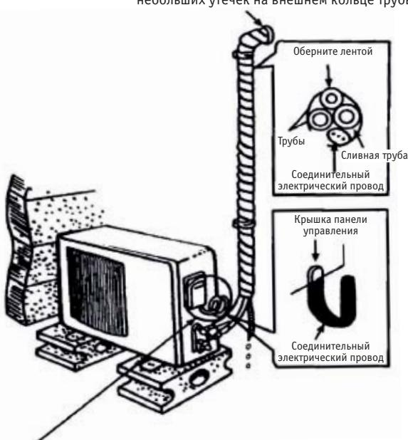
Придайте проводу такую форму, как на рисунке, чтобы предотвратить попадание воды в электрические детали
