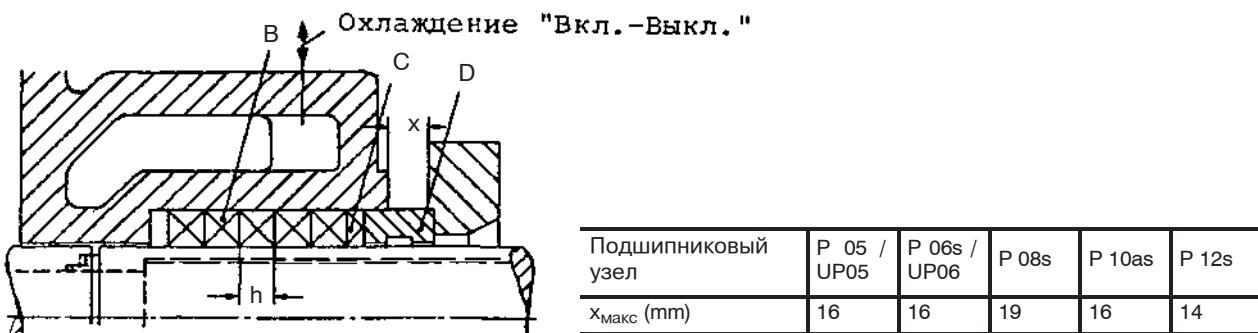
Рис. 4 Охлаждаемое исполнение/подшипниковые узлы
