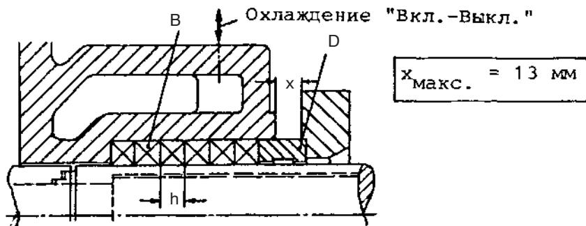
Рис. 3 Охлаждаемое исполнение/подшипниковые узлы
