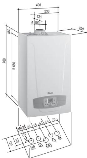
MR: Подача в систему отопления 3/4" m
