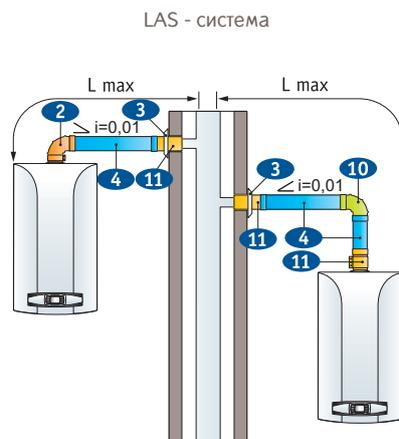
Коаксиальная труба с вертикальным выходом
