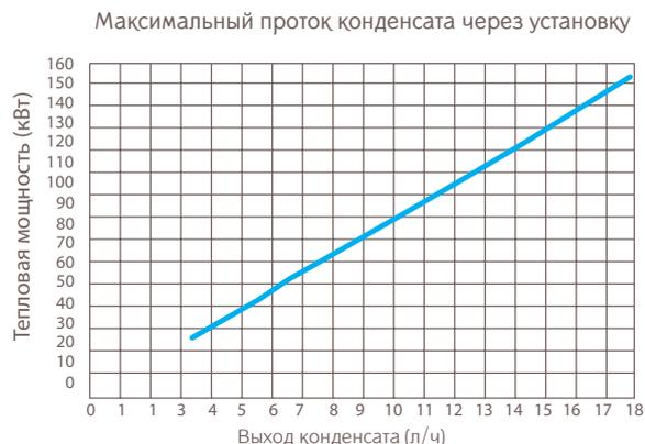
Из графика можно определить максимально возможное количество конденсата в зависимости от потребляемой мощности для всех моделей котлов LUNA Duo-tec и POWER HT. При следующих условиях:
