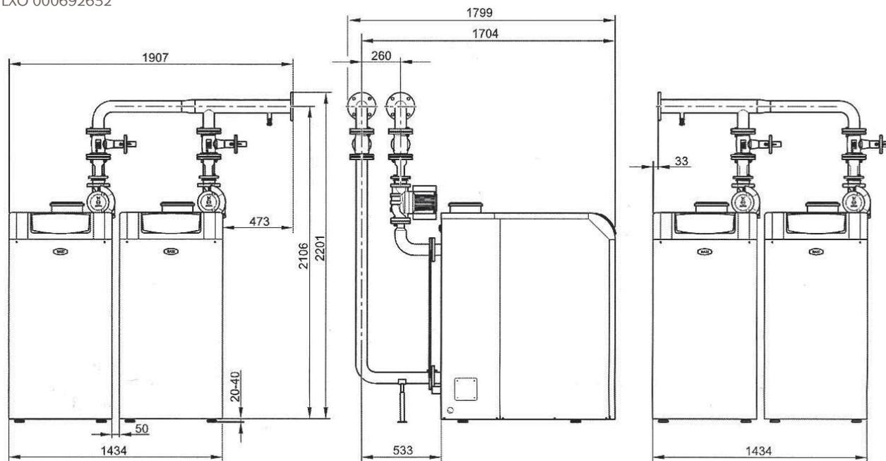
Гидравлический комплект для соединения двух котлов POWER HT 1.280 или 1.320 в каскад.
