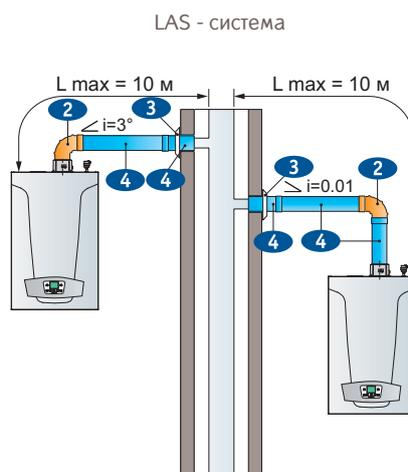
Коаксиальная труба с вертикальным выходом
