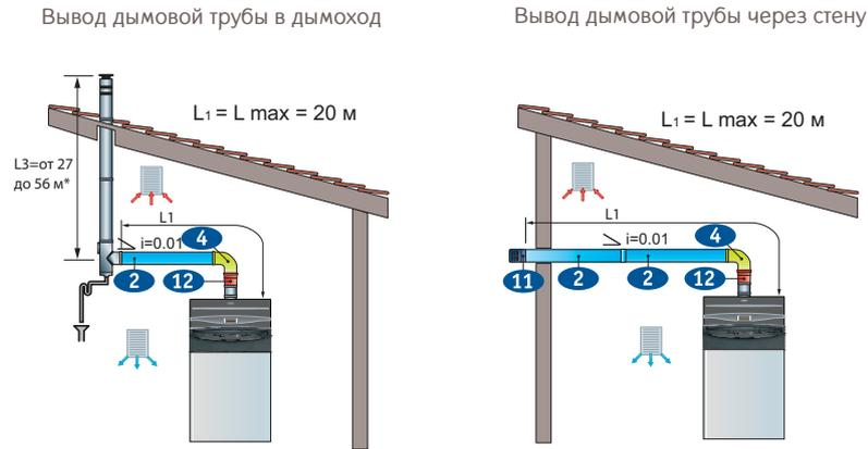
Примечание: Максимальная длина дымовых труб до вертикального ствола дымохода не более 20 м для всех моделей (не более 30 м для POWER HT 1.450)
