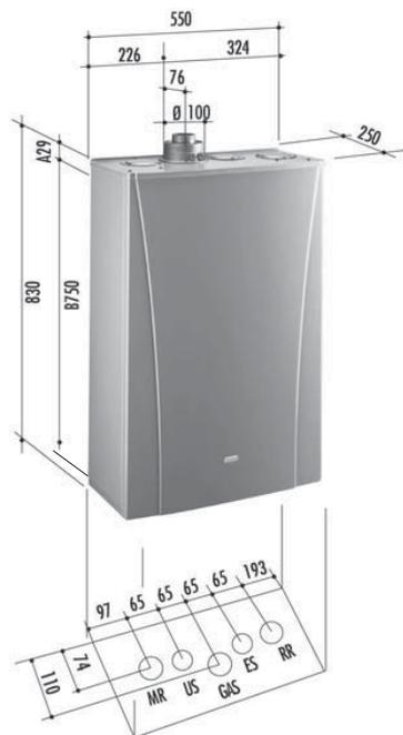
MR: Подача в систему отопления 3/4" m
