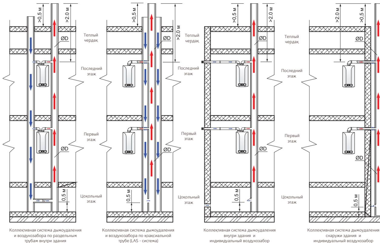
Рекомендуемый диаметр коллективного дымохода при подключении нескольких настенных котлов
