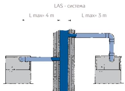
Коаксиальная труба с вертикальным выходом
