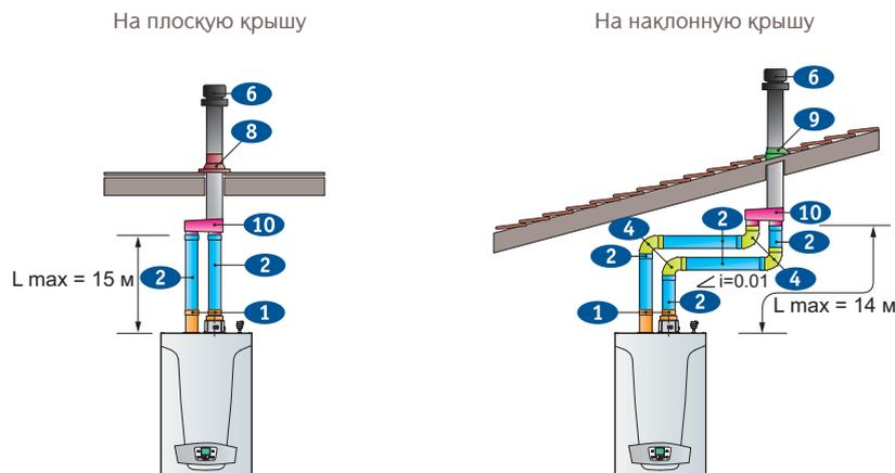
Примечание: На схемах указан уклон и его направление.  $i=0.01$  означает уклон 1 см на каждый 1 метр длины дымовой трубы
