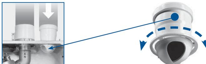
СИСТЕМА AFR ПРИМЕНЯЕТСЯ ПРИ ОРГАНИЗАЦИИ ПРИТОКА ВОЗДУХА И ОТВОДА ПРОДУКТОВ СГОРАНИЯ ПО РАЗДЕЛЬНЫМ ТРУБАМ. ИСПОЛЬЗУЕТСЯ ДЛЯ КОТЛОВ СЕРИЙ MAIN 5, MAIN FOUR, ECO FOUR, FOURTECH, LUNA-3, LUNA-3 COMFORT, NUVOLA-3 B40, NUVOLA-3 COMFORT, SLIM.
