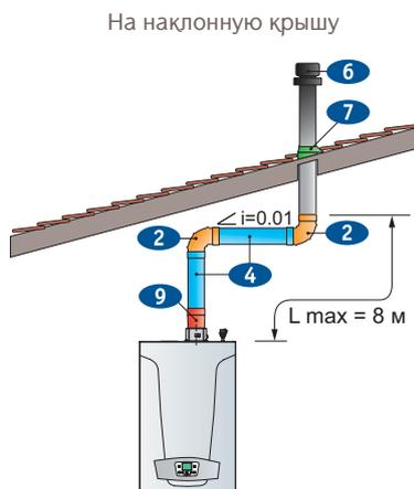
Примечание: На схемах указан уклон и его направление.  $i=0.01$  означает уклон 1 см на каждый 1 метр длины дымовой трубы
