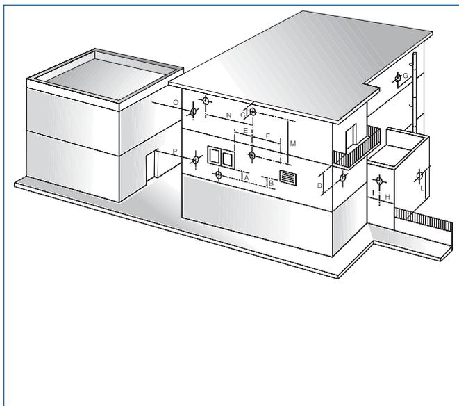
В пространство, ограниченное с четырех сторон, но открытое сверху (вентиляционные шахты, колодцы, внутренние дворики и т.п.) допускается напрямую выводить продукты сгорания газовых отопительных приборов с естественной или принудительной тягой и мощностью от 4 до 35 кВт при обязательном соблюдении следующих условий:
