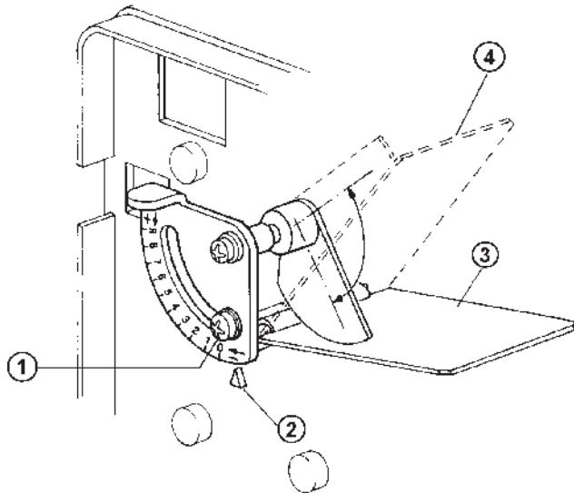
1) Винт регулировки открытия воздушной заслонки
