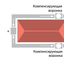
Если водосточные желоба образуют замкнутую систему из 4 сторон, как показано на рис. D, то необходимо применять компенсирующие воронки и компенсаторы в комплексе.\*
