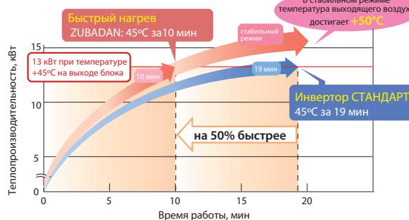
Температура наружного воздуха  $-20^{\circ}\text{C}$
