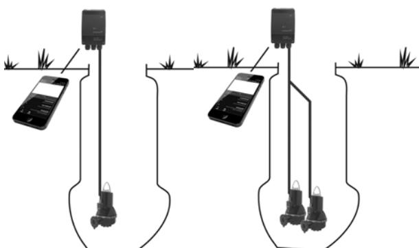
**Рис. 5** Конфигурация с одним или двумя насосами AUTO<sub>ADAPT</sub> с устройством CIU
