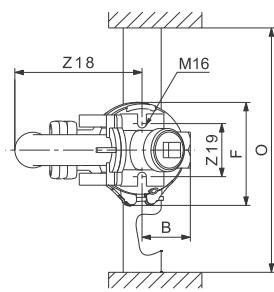
Рис. 23 Установка на надводной автоматической трубной муфте
