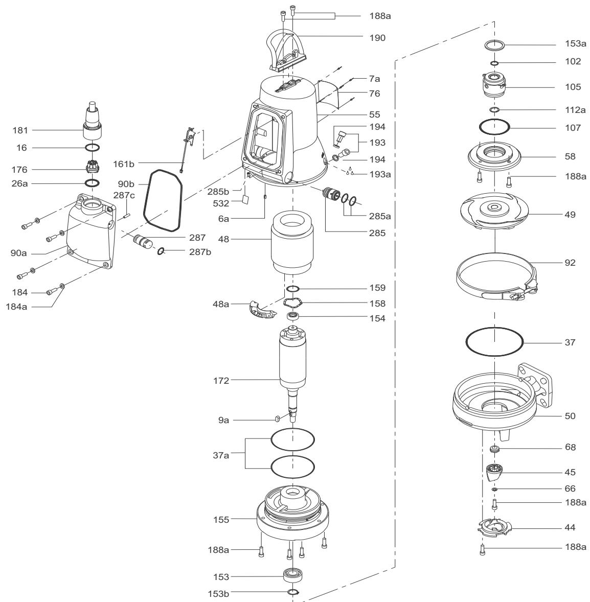
Рис. 15 Деталировка насоса AUTO<sub>ADAPT</sub>, 2,6, 3,1 и 4,0 кВт
