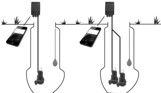
**Рис. 4** Конфигурация с одним или двумя насосами AUTO<sub>ADAPT</sub> с устройством CIU и реле контроля уровня - вариант 1
