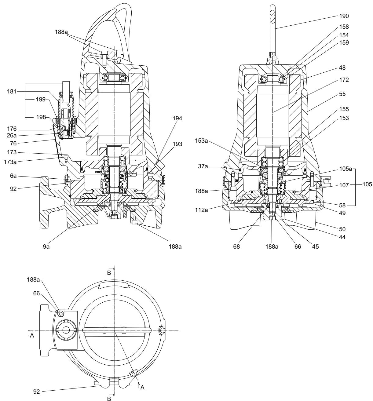
Рис. 10 Чертеж насоса SEG в разрезе, 2,6, 3,1 и 4,0 кВт
