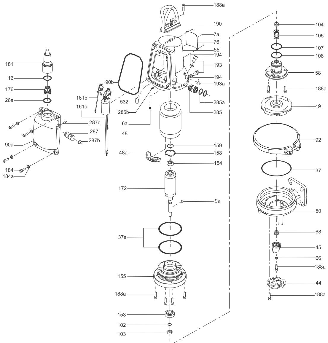
Рис. 13 Детализировка насоса SEG AUTO<sub>ADAPT</sub> в разрезе, 0,9, 1,2 и 1,5 кВт
