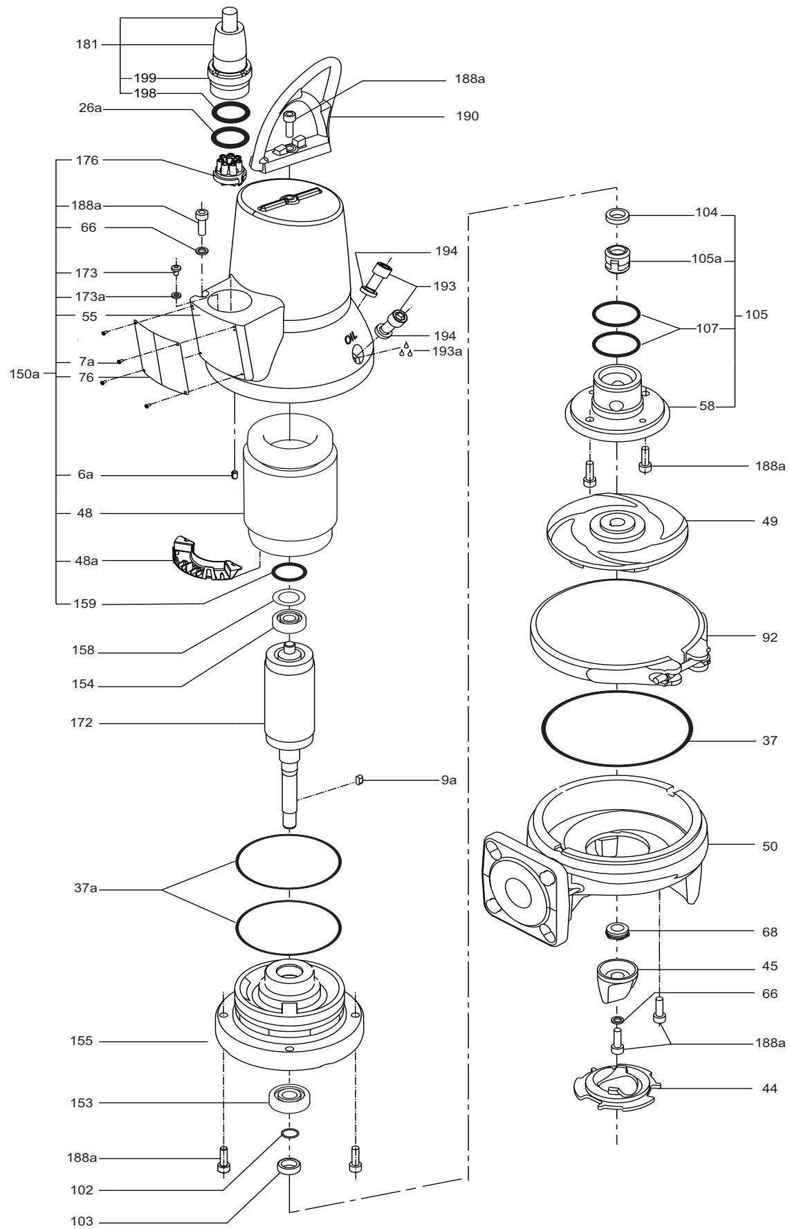
Рис. 9 Детализировка насоса SEG, 0,9, 1,2 и 1,5 кВт
