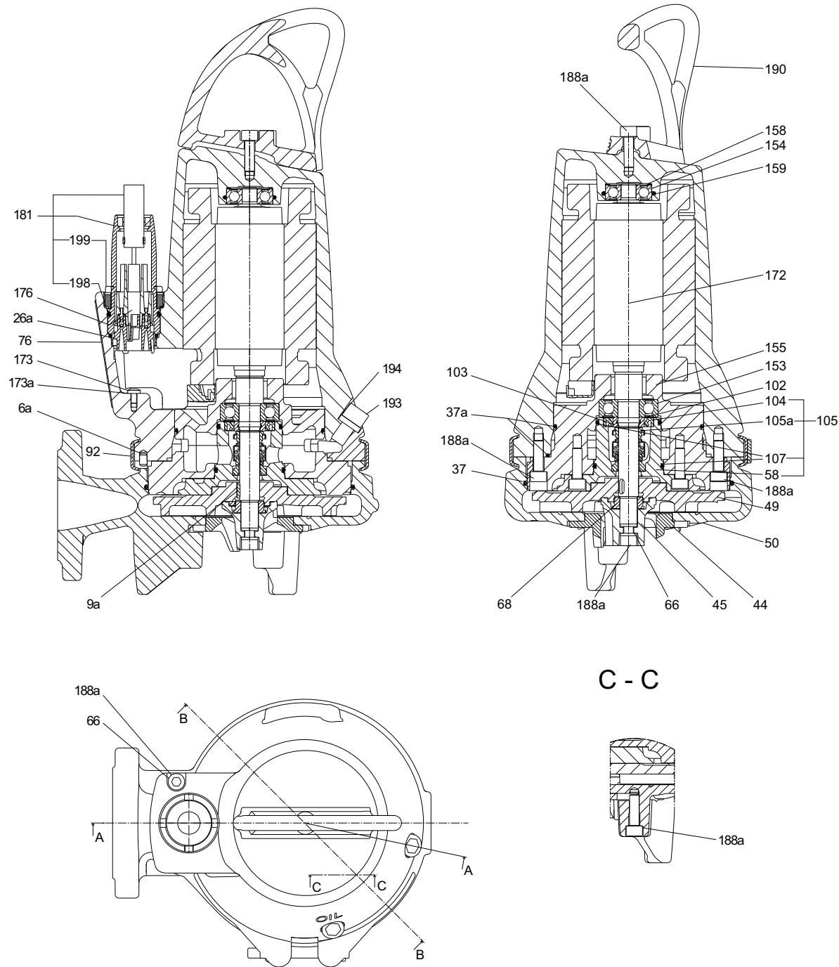
Рис. 8 Чертеж насоса SEG в разрезе, 0,9, 1,2 и 1,5 кВт
