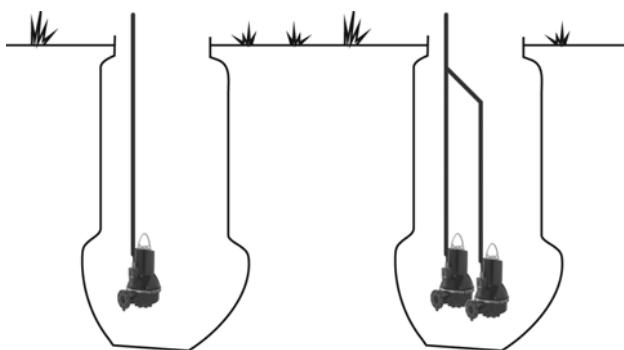
**Рис. 3** Конфигурация с одним или двумя насосами AUTO<sub>ADAPT</sub>
