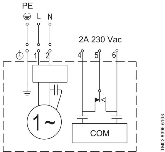
**Рис. 20** Схема соединений для насосов SEG AUTO<sub>ADAPT</sub> с однофазными электродвигателями
