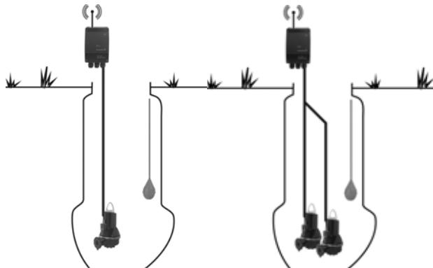
**Рис. 6** Конфигурация с одним или двумя насосами AUTO<sub>ADAPT</sub> с устройством CIU и реле контроля уровня - вариант 2
