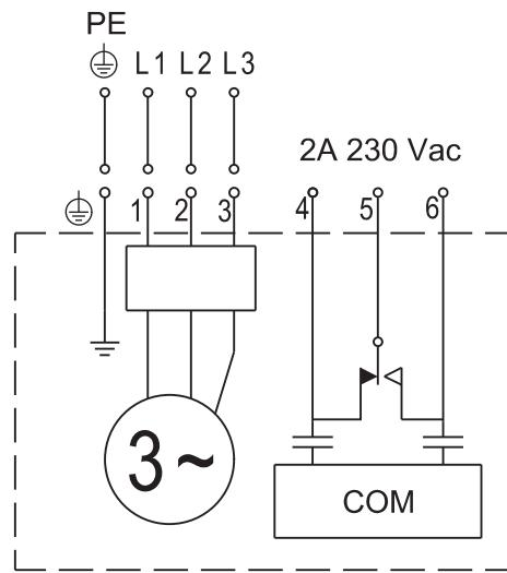
**Рис. 22** Схема соединений для насосов SEG AUTO<sub>ADAPT</sub> с трехфазными электродвигателями
