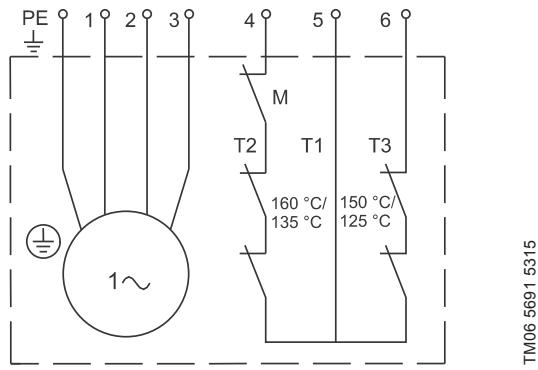
**Рис. 19** Схема соединений для насосов SEG с однофазными электродвигателями. Смотрите таблицу.
