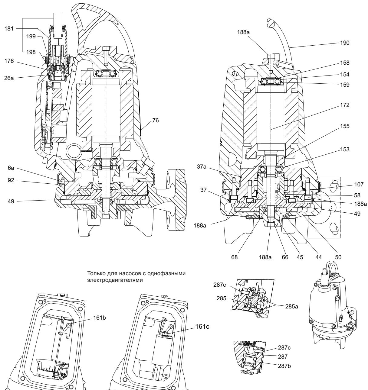
Рис. 12 Чертеж насоса SEG AUTO<sub>ADAPT</sub> в разрезе, 0,9, 1,2 и 1,5 кВт
