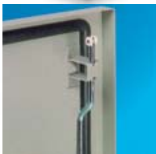
Прокладка из вспененного полиуретана, наносимая методом одностадийной заливки с помощью роботов на все открывающиеся дверцы и фланцы.
