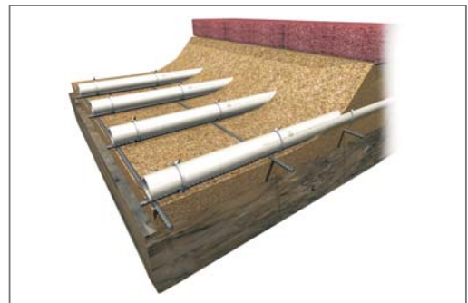
Напольное отопление на открытых пространствах
