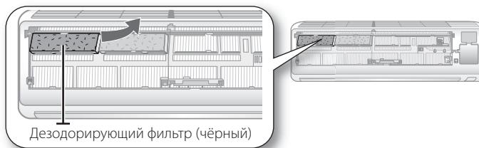
Фильтр-дезодоратор допускается устанавливать в одну из четырех кассет, расположенных под воздушным фильтром.
