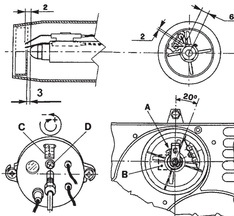
После монтажа форсунки проверьте правильное позиционирование электродов и диска в соответствии с нижеуказанными в мм. отметками. Будет хорошим правилом если Вы проверите отметки после выполнения операций на головке.
