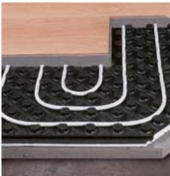
**Маты:** на плоскую поверхность укладываются маты, с или без изоляции. Трубы устанавливаются между бобышками маты. Сверху заливается бетон с пластификатором.
