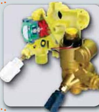
Электронный датчик расхода горячей воды (ГВС) запатентованной конструкции – вращающаяся в потоке воды турбинка – не имеет уплотнений и связана со считающим устройством лишь магнитной связью через герметичную стенку датчика. Это исключает негерметичность и дает электронике котла очень точный сигнал о расходе воды.
