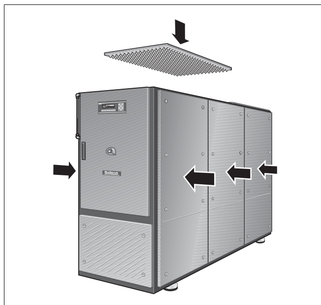
Рис. 20 Установка элементов шумопоглощающего кожуха
