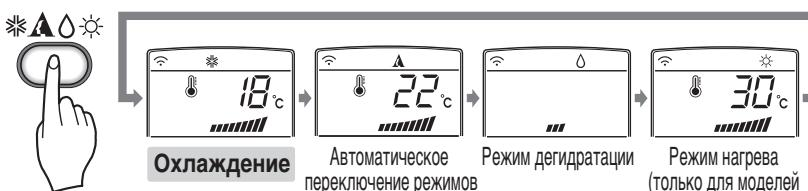
Работа в автоматическом режиме (Для моделей только с режимом охлаждения)
