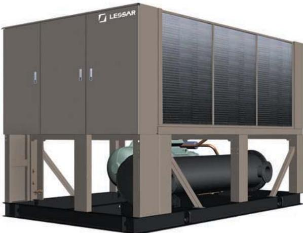
Модульные чиллеры LESSAR с воздушным охлаждением конденсатора и винтовыми полугерметичными компрессорами — высокоэффективные холодильные машины с холодопроизводительностью от 360 до 7200 кВт. Такой широкий диапазон холодопроизводительности достигается благодаря возможности этих чиллеров работать в режиме ведущий/ведомый при объединении до восьми модульных чиллеров в единую систему ходоснабжения.
