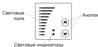
Рис. 17 Панель управления насосом с однофазным электродвигателем
