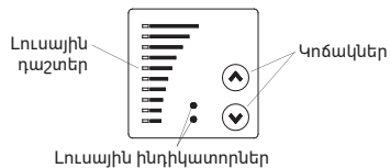
Նկար 17 Միաֆազ էլեկտրական շարժիչով պոմպի կառավարման վահանակ
