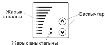
Сүрөт 17 Бир фазалуу электр кыймылдаткычы менен насостун башкаруу панели
