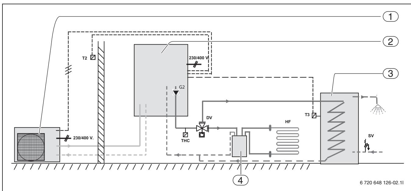
Рис. 1 Внешний блок ODU, модуль WPLS с баком-водонагревателем и контуром тёплых полов
