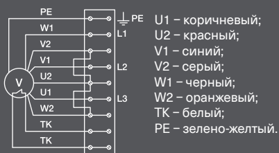
Схема 3 (Δ — 400 В, 3 ф.)
