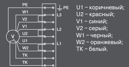
Схема 3 (Δ — 230 В, 3 ф.)
