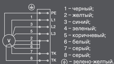
Схема 4 (400 В, 3 ф.)
