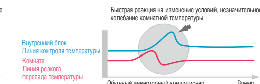
Соотношение между изменением температуры и мощностью неинверторного компрессора (при обогреве).
