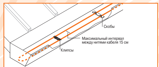
Рис.3.14. Укладка кабеля в желобе в две нити
