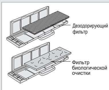
*В комнатный блок могут быть установлены дезодорирующий фильтр и фильтр Bio-Pure (Биологической очистки) для удаления мельчайших частичек пыли или запахов. Срок службы фильтра равен приблизительно трем месяцам, хотя он может изменяться в зависимости от интенсивности использования кондиционера.*
