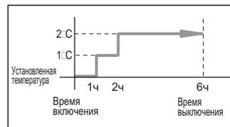
**Обогрев** Установленная температура понижается на 1°C в час. Когда она понизилась на 2°C (через два часа), температура поддерживается на этом уровне в течение четырех часов.
