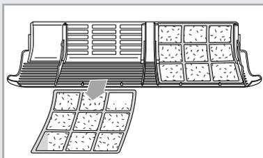
*Чтобы получить наилучшие результаты при эксплуатации вашего кондиционера, вы должны регулярно чистить его для удаления пыли, скапливающейся на воздушном фильтре.*
