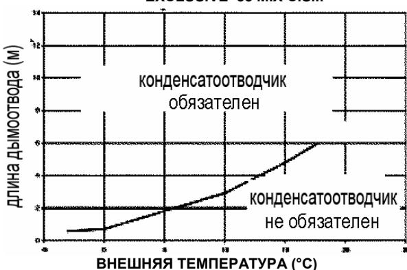
⚠ При прокладке некоторых участков дымоотвода по улице, при расчете максимально допустимой длины без конденсатоотводчика, учитывайте уличную температуру, а не температуру в месте установки котла.
