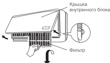
После чистки, для снятия данной индикации необходимо нажать и удерживать в течение 5-10 секунд кнопку автоматического режима работы на внутреннем блоке кондиционера. Данная индикация не влияет на работу прибора и служит только для того, чтобы напомнить о необходимости чистки фильтров.
