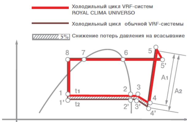
затраченная системой Universo меньше работы A2 обычной системы за счет того, что инженеры ROYAL Clima снизили потери давления на всасывание в контуре (участок 4'-4) и увеличили температуру испарения фреона в контуре (участок 1-2). Таким образом, при снижении затрат на сжатие хладагента, уменьшается потребление энергии компрессором и увеличивается эффективность цикла в целом.
