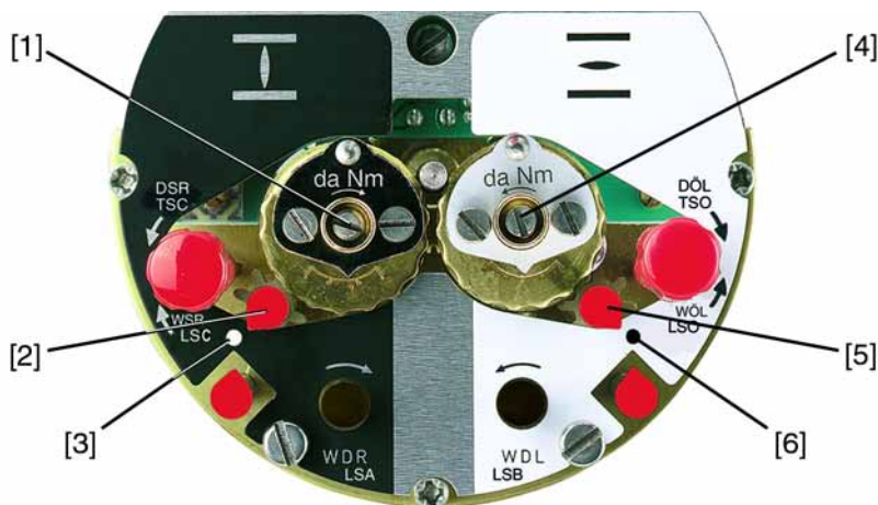
рис. 23: Регулировочные элементы концевого выключателя
