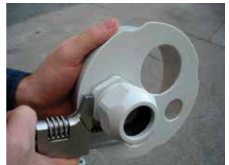
3. Установить и зафиксировать кабельные вводы.
