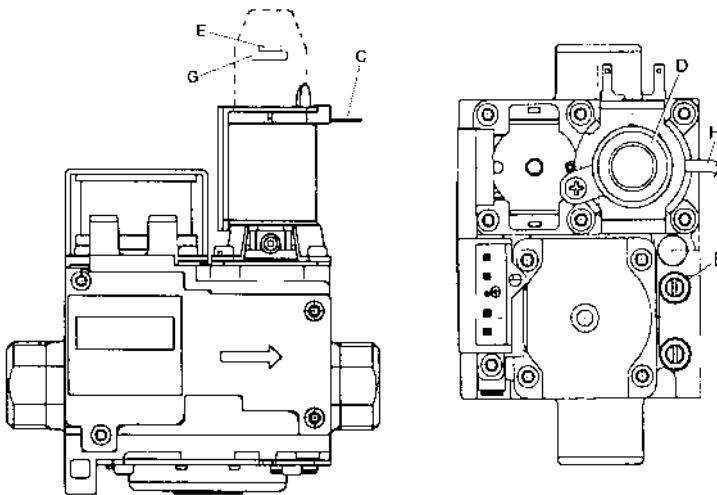
рис. 27 - Газовый клапан
