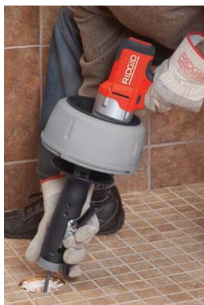
3/8" (10 мм) спираль в модели K-45AF-5 расширяет возможности машины, позволяя прочищать сточные трубопроводы диаметром до 2 1/2" (75 мм)
