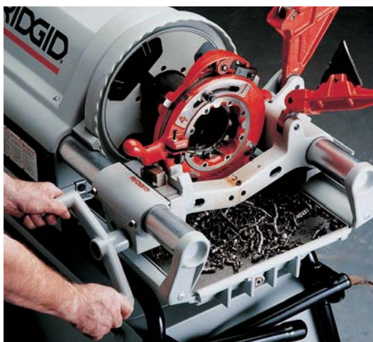
Резьбонарезная головка со ступенчатой регулировкой модели 714 (914).
