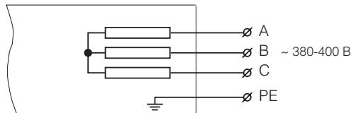
Рис. 2. Обогреватель BIH-T-3.0; BIH-T-4.5, BIH-T-6.0
