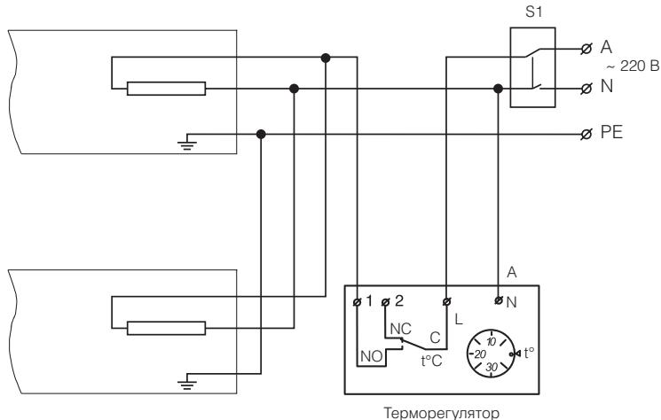
Рис. 3. Обогреватель BIH-T-3.0; BIH-T-4.5, BIH-T-6.0
