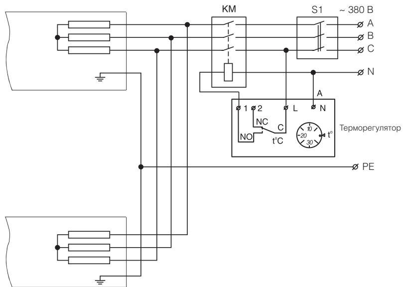
Рис. 4. Обогреватель BIH-T-3.0; BIH-T-4.5, BIH-T-6.0
