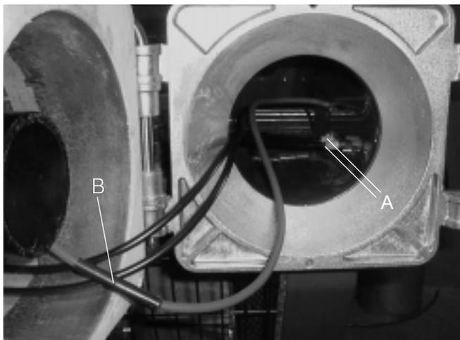
Вставьте корпус горелки в шарнир газовой обоймы и закрепите его при помощи крепёжного стержня. Горелка находится при этом в сервисном положении.
