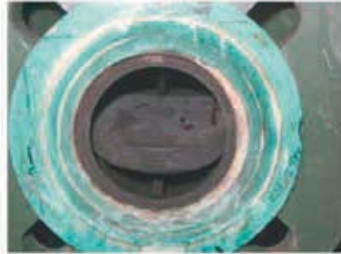
Створчатый клапан, застывший в полу-открытом положении из-за разбухания
