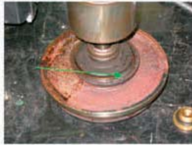
Деформированный фланец – сальник корпуса двигателя
