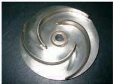
Рабочее колесо FEKA VX 1000, перекачивающее воду с песком в течение 3500 часов (146 дней непрерывной работы)
