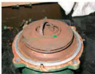
Следы масла и загрязнения рабочего колеса
