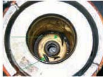
Поврежденный сальник корпуса двигателя
