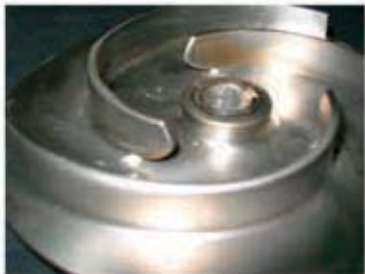
Рабочее колесо для FEKA VX 1000 с изношенными песком лопастями
