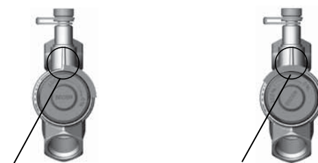
Рис. 39. Грубая настройка клапана БРОЕН Dynamic на расчетный расход (без расходомера)
