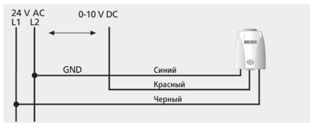
Рис.51. Схема подключения привода
