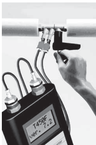
Рис.7 Измерение расхода на клапане БРОЕН Venturi
