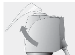
Рис.52. Крышка-секретка для защиты привода
