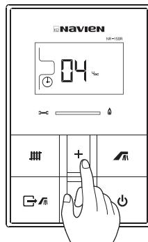
Когда мигает значок нажмите кнопку + или – и выберите желаемое время повторной работы отопления в пределах 0~12 часов, информация сохраняется автоматически. За единицу времени принимается 1час. Если установить время остановки на (04), как изображено на рисунке, то котел будет работать в течении 30 мин. каждые 4 часа.
