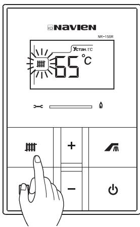
2. Нажав кнопку + или – установите желаемую температуру отопления.
