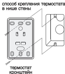
При соединении проводов не следует прикладывать чрезмерные усилия, кронштейн надежно закрепите болтами.
