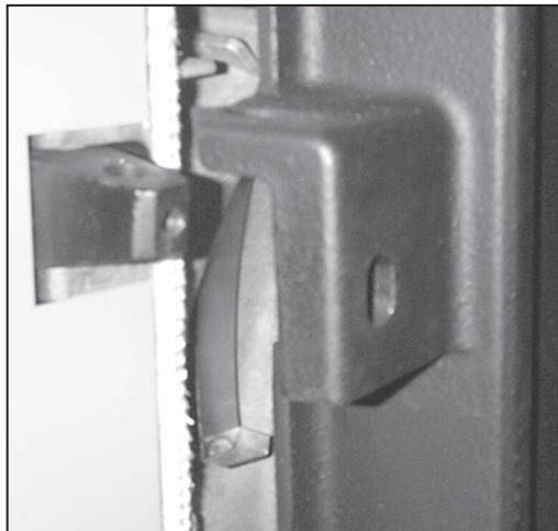
3. Закрепите переднюю дверцу на передней секции с помощью 4 винтов M10x30 (136) и прокладок A10.5 (137)
